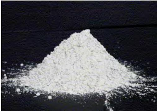
主要成分 (CaO、Al<sub>2</sub>O<sub>3</sub>、SiO<sub>2</sub>、Fe<sub>2</sub>O<sub>3</sub>)
